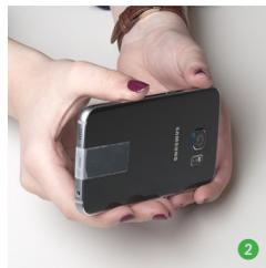
**1** Fije la tira adhesiva más larga en la parte inferior de la hoja protectora y coloque esta en su posición exacta sobre el aparato.
