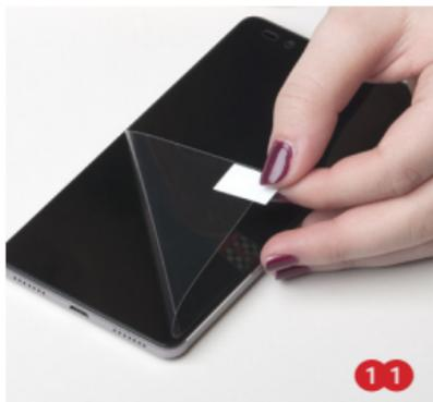
**11** Il faut maintenant retirer le **film de protection du produit** à l'aide de la **languette** :
