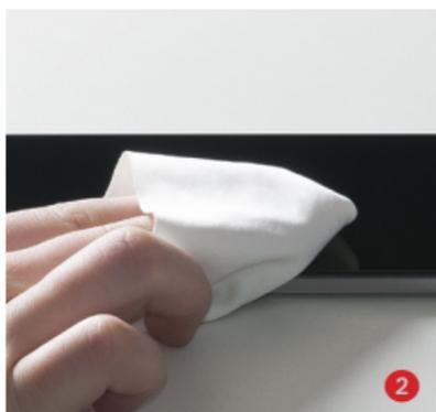
**2** + **3** Nettoyez bien l'écran en frottant avec le chiffon en microfibres. Retirez les traces tenaces avec un produit adapté.
