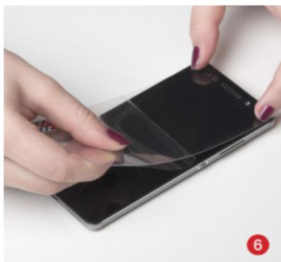
**6** Lorsque le film est parfaitement aligné, approchez le film de protection de l'écran en l'effleurant. Grâce à l'attraction, la partie supérieure du film est maintenant posée sur l'écran.
